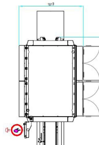
Maschinenhöhe bei geschlossener Folienrollentür: 2095 mm
