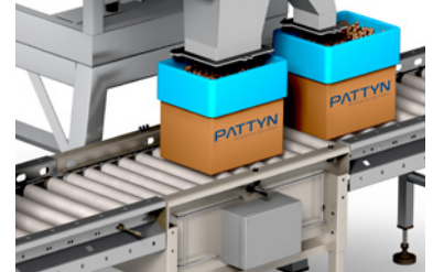
Fina dosificación en tolva de pesaje separada para justo después de la caída
