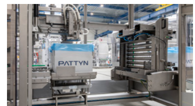
Kippbares Einlaufrollenbahn für einfache Reinigung
