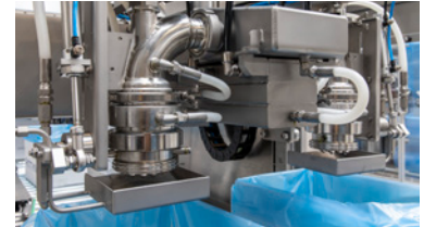
90° abgewinkeltes Füllventil mit Tropfenauffangblech
