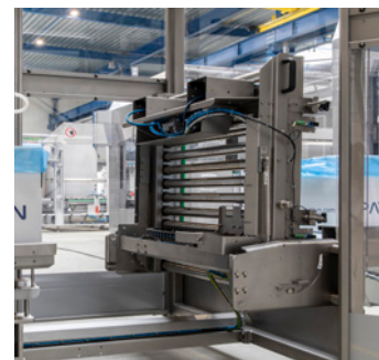
Convoyeur d'alimentation inclinable pour un nettoyage facile
