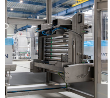
Cinta de alimentación abatible para facilitar la limpieza
