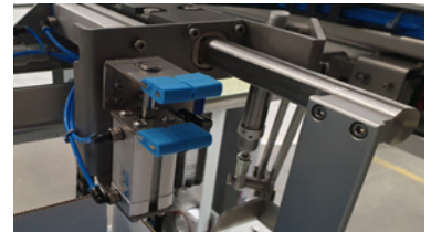
Nuevo y resistente módulo de cuchara y pinza
