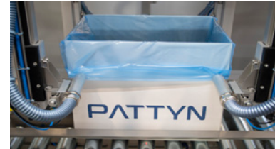
Decompressione del sacco a vuoto (opzionale)
