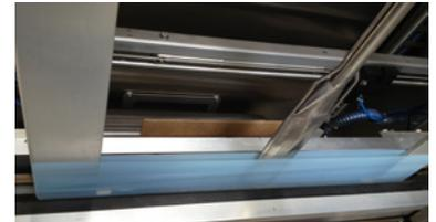
Pinza para desplegar la bolsa con control de despliegue integrado
