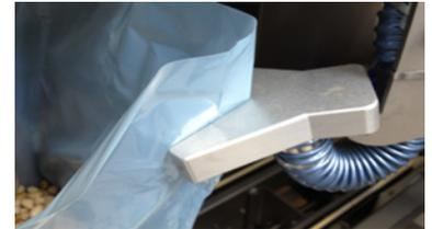
Despliegue de la bolsa por vacío
