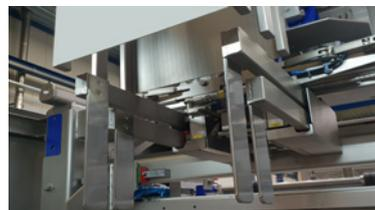
Module de pinces actionné par un moteur pas à pas
